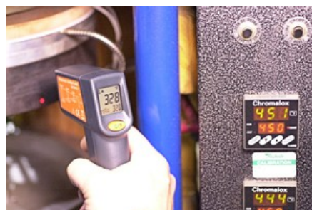
Рисунок 6 Температура поршней без лазера (328°F)
