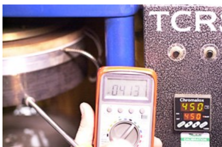
Рисунок 5 Температура поршней без зондов (413°F)
