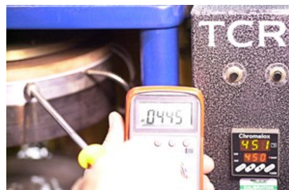
Рисунок 4 Температура рядом с нагревательным элементом (445°F)
